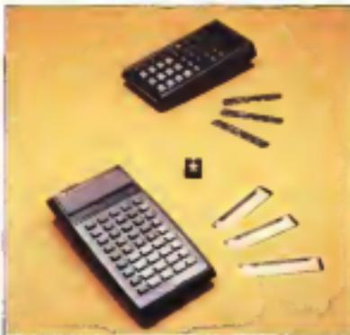
Foto 4. Al centro della foto c'è il modulo RPN simulatore in primo piano la TI 58 e nelle sfondo l'HP 87 insieme con le sue schede
